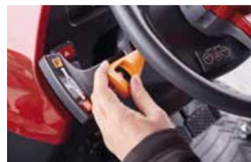
Contrôle avant et arrière du bout des doigts
