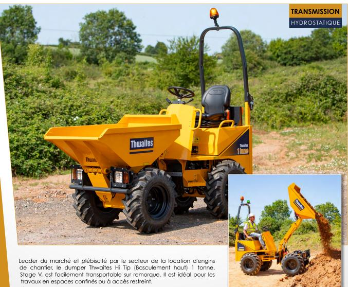
Équipés d'un moteur Yanmar d'une puissance de 15,9 kW et fournissant 66,4 N.m de couple pour une traction optimale, les dumpers de la gamme Thwaites 1 Tonne sont parfaitement adaptés à vos besoins en se déclinant également dans la version suivante :
