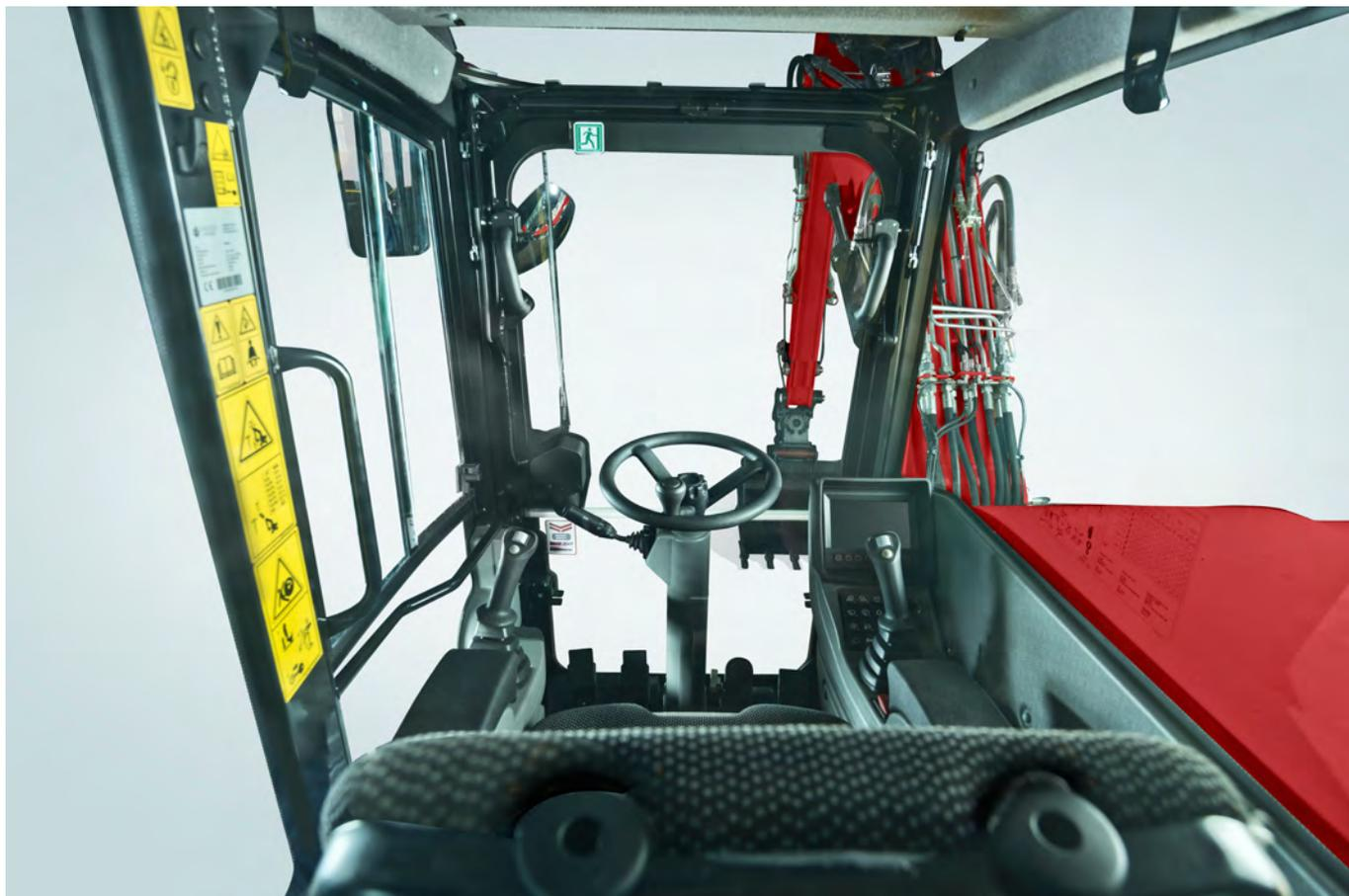
Conçue dans un souci de confort pour l'opérateur et de productivité, la cabine présente un amortissement du bruit et des vibrations et est homologuée ROPS. (FOPS en option.)
