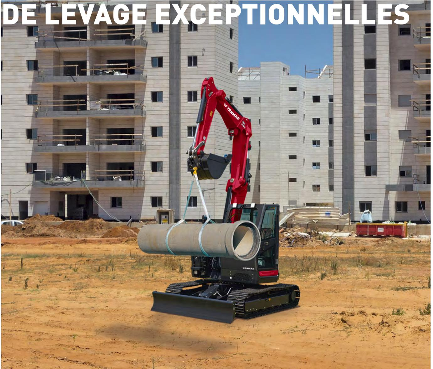
La B7 Sigma-6 offre une stabilité exceptionnelle grâce à la conception unique et au point de rotation qui se situe près du centre de gravité de la machine. Par conséquent, la B7-6 est l'outil optimal pour le levage et le déplacement de charges.
