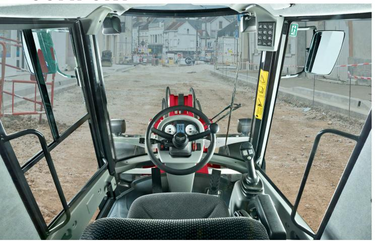
Établissant la norme en matière de confort et de productivité, la cabine conforme aux normes ROPS et FOPS est dotée d'une technologie d'amortissement du bruit et des vibrations de pointe.
